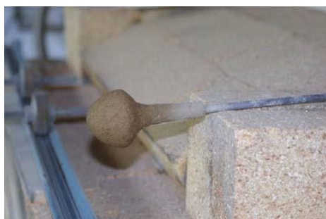
Εικόνα 6. Πειραματική αποκατάσταση μετάλλινης ράβδου με πυρήνα από πηλόχωμα (Nicholson, 2011: σ. 4, εικ 2).
