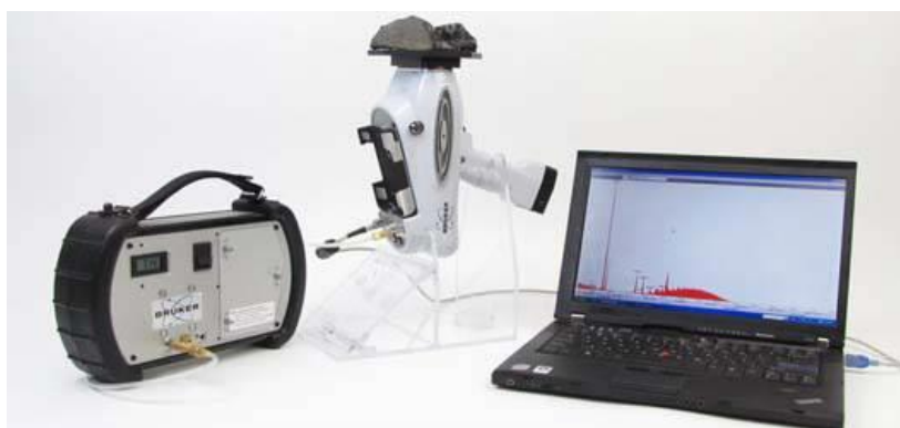
Εικόνα 2. Φορητό σύστημα Φθορισμομετρίας Ακτίνων -X (υπο-προγράμματα) της εταιρείας Bruker (μοντέλο Tracer IV), Εργαστήριο Αρχαιομετρίας, Τμήμα Ιστορίας, Αρχαιολογίας και Διαχείρισης Πολιτισμικών Αγαθών, Πανεπιστήμιο Πελοποννήσου.
