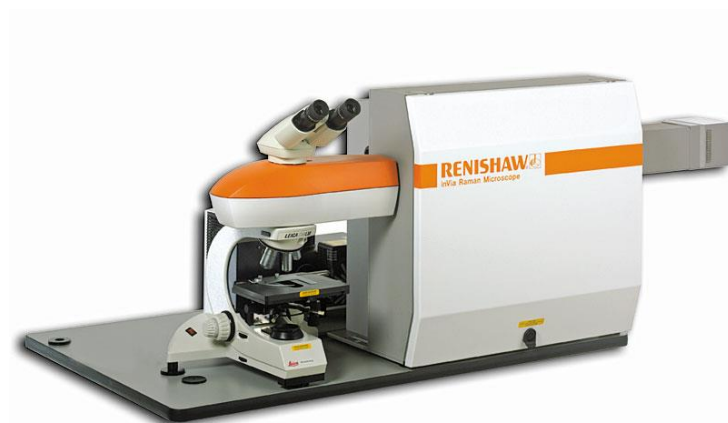
Εικόνα 4. Συνεστιακός φασματογράφος micro-Raman, εφοδιασμένος με οπτικό μικροσκόπιο της εταιρίας Renishaw. Ινστιτούτο Θεωρητικής και Φυσικής Χημείας, Εθνικό Ίδρυμα Ερευνών.
