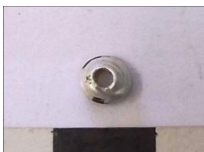
Εικόνα 10. Δείγμα B64. Περιέλιξη με συλλογή γυαλιού εμφανής και μακροσκοπικά.
