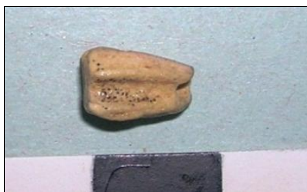
Εικόνα 19. Δείγμα Μ11. Εκτενής διάβρωση σώματος φαγεντιανής, απώλεια υαλώματος, αρχικού χρώματος, βελονισμοί.
