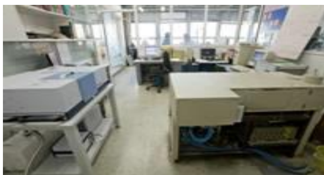
Εικόνα 5. Συστήματα Bruker vacuum FTIR , Vertex 80v (αριστερά) και IFS 113v (δεξιά). Ινστιτούτο Θεωρητικής και Φυσικής Χημείας, Εθνικό Ίδρυμα Ερευνών.
