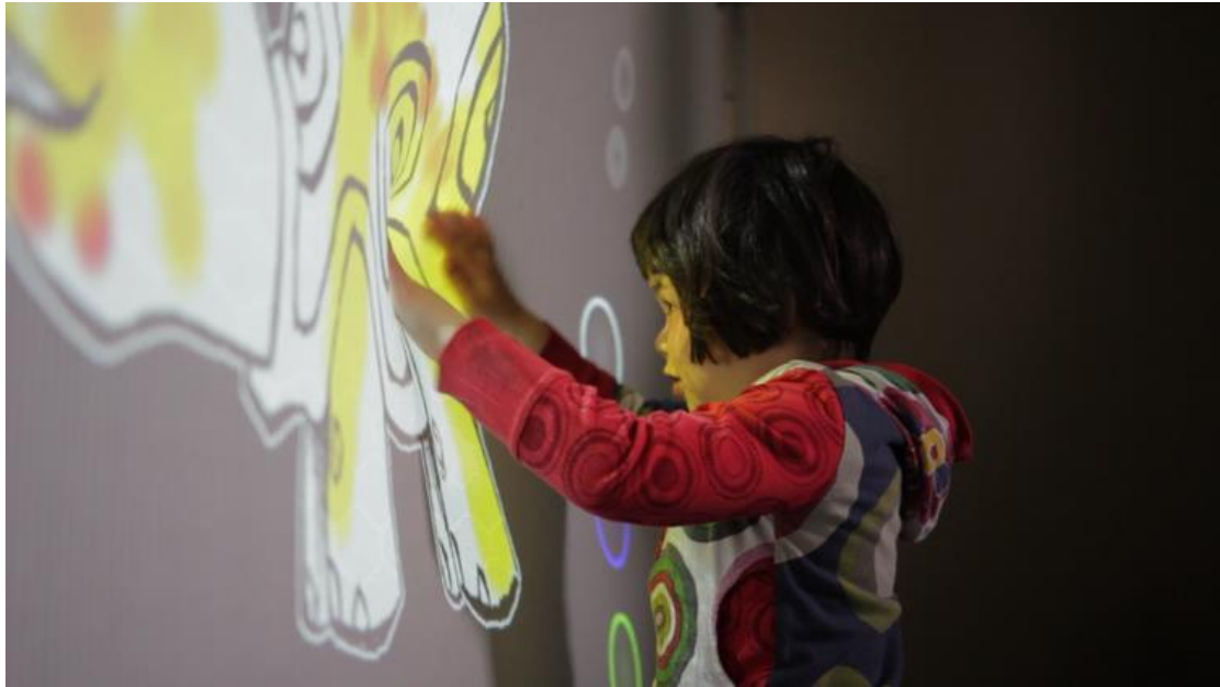
Εικόνα 2 Η αισθητηριακή ΕΠΙΦΑΝΕΙΑ | Το πρωτότυπο stretchCOLOR, όπου η πίεση που εφαρμόζεται στο 2D ύφασμα καθορίζει το χρώμα που προβάλλεται στην επιφάνεια. 4
