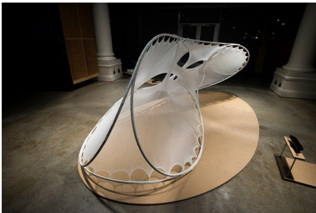
Εικόνα ISensory[STRUCTURE] - Υβριδική δομή κλωστοϋφαντουργίας που αποτελείται από πλεκτά υφάσματα CNC διασυνδεδεμένα με ράβδους πολυμερούς ενισχυμένου με ίνες γυαλιού (GFRP) 3
