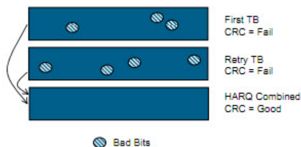
Εικόνα 2.18:Λειτουργία πρωτοκόλλου HARQ [4]
