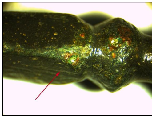
Images 3.1-10. Casting marks on pins ALEA-P1, -P3, -P4, -P5, -P5, -P6, -P7, -P8, -P11, -P26
