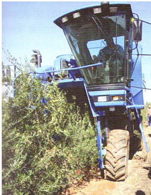
Εικ. 59 Συγκομιδή. Μάζεμα ελαιόκρπου με μηχανοκίνητο συλλέκτη σε υπέρπυκνη καλλιέργεια
