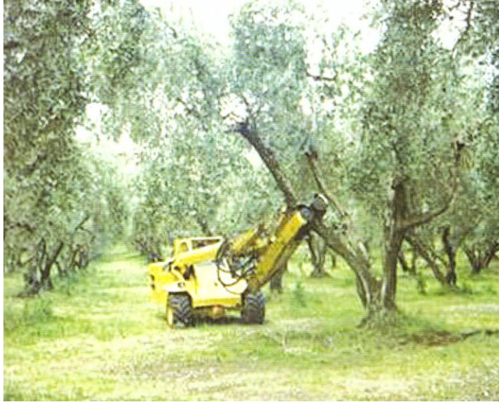
Εικ. 58 Συγκομιδή. Μάζεμα ελαιόκρπου με δονητή βραχιόνων-κορμού
