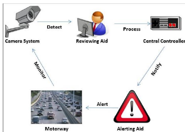
Εικόνα 12: Διάγραμμα λειτουργίας συστήματος ελέγχου κυκλοφορίας με κάμερες υψηλής ανάλυσης (Πηγή: Zhou&Wu, 2022).
