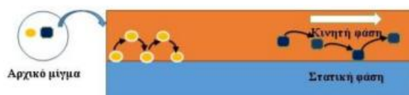
Σχήμα 24: Αρχή διαχωρισμού συστατικών μειγμάτων με την τεχνική της χρωματογραφίας[Lloyd 2011]
