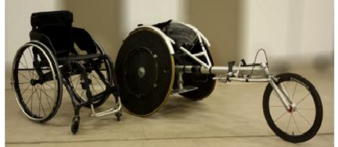
Εικόνα10: Αμαξίδιο ελαφριού τύπου από αναθρακονήματα καθημερινής χρήσης (αριστερά) σύγκριση του αγωνιστικού τροχήλατου (δεξιά). (Woods & Watson, 2004)
