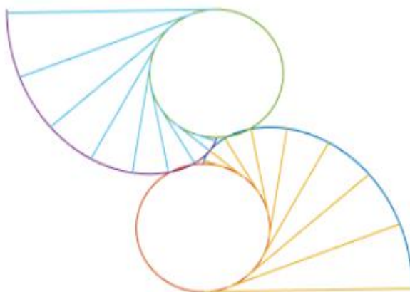
Σχήμα 2.6: Ελικοειδές προφίλ κατά την επαφή δόντι με δόντι
