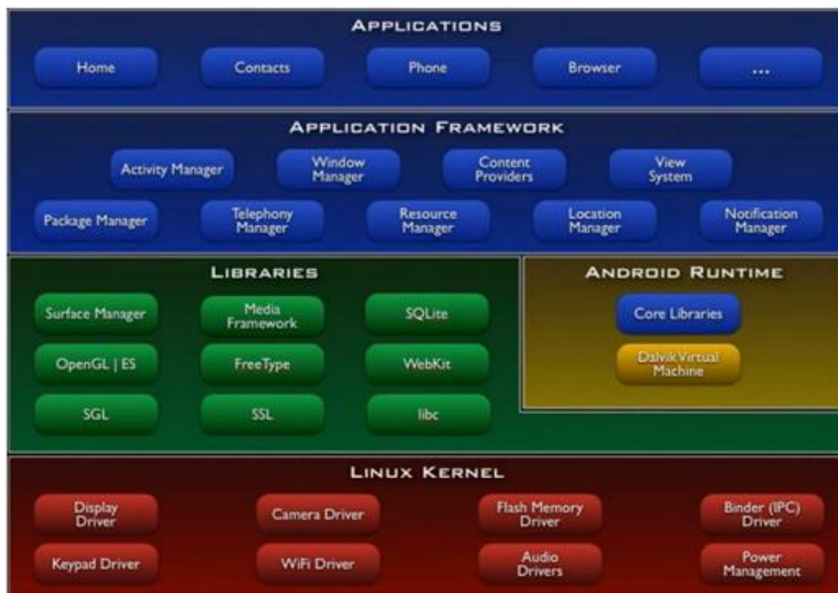
Σχήμα 4: Επίπεδα Αρχιτεκτονικής λειτουργικού συστήματος Android
