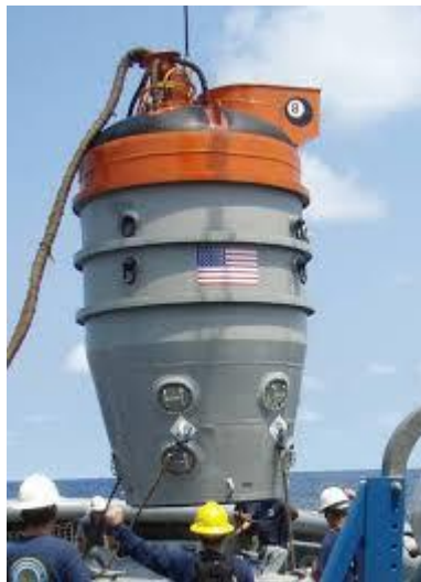
Εικόνα4. Κώδωνας διαφυγής – SRC (πηγή: (OceanWorks International, 2018).
