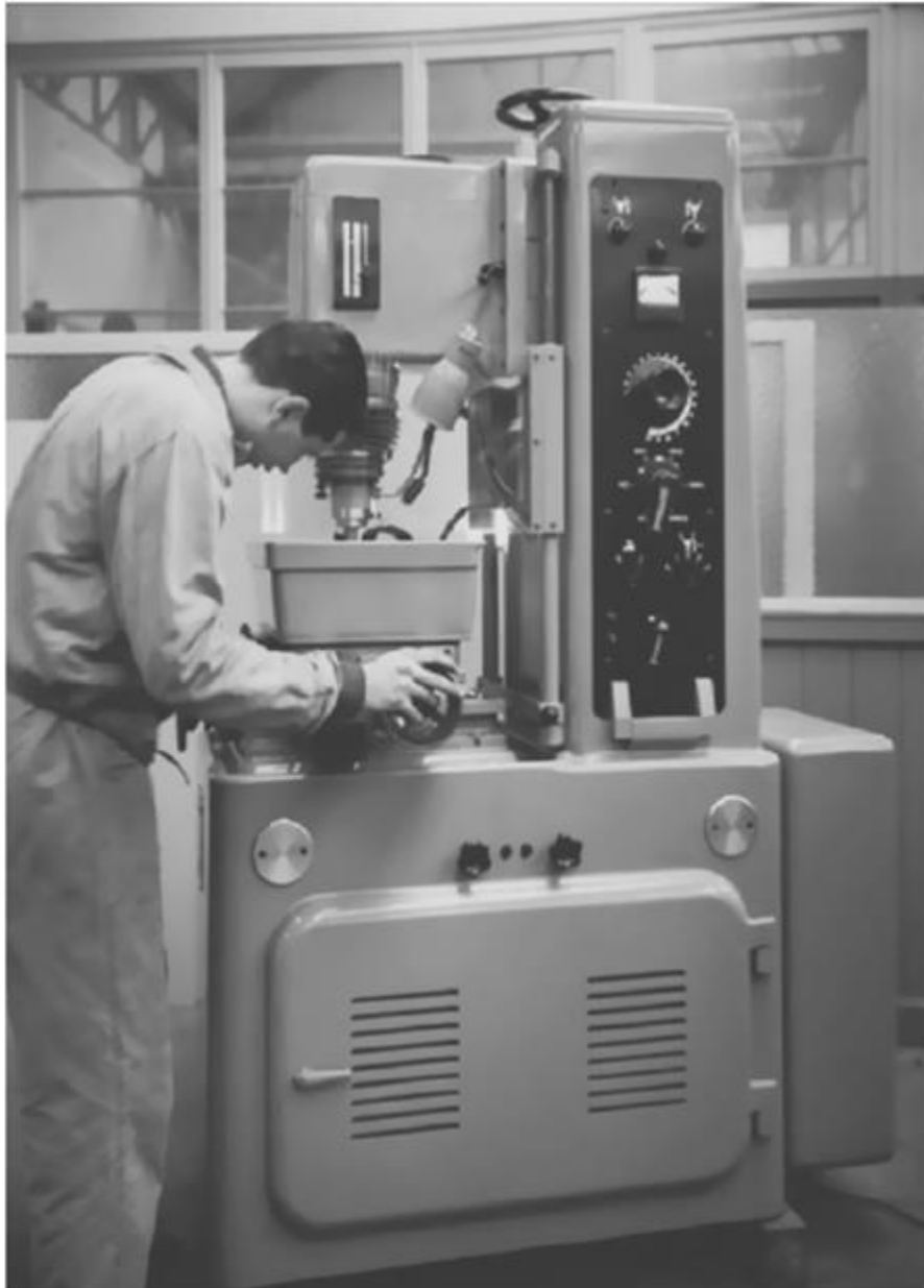
Εικόνα 1-3 Πρώτη βιομηχανική μηχανή EDM στον κόσμο. Παρουσίαση του Eleroda D1 στην έκθεση EMO στο Μιλάνο. Ιταλία, 1955. (Courtesy of Charmilles, 560 Bond St., Lincolnshire, IL.) ( https://ebrary.net/ )
