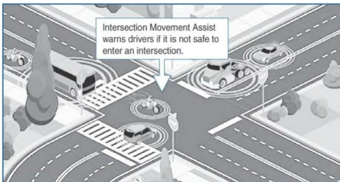
Σχήμα 4: Εφαρμογή Intersection Movement Assist (IMA).
