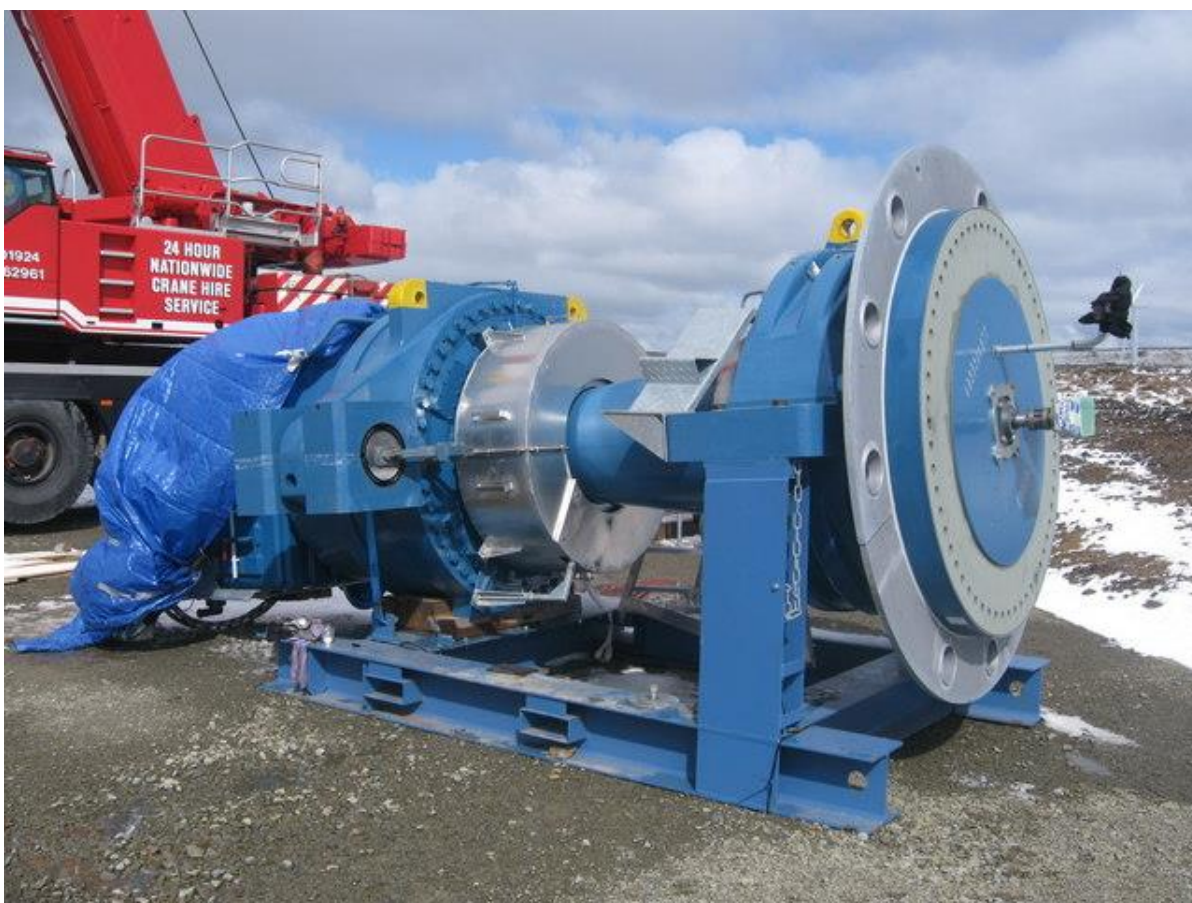
Εικόνα 33: Σύστημα κιβωτίου ταχυτήτων δρομέα και δισκόφρενού ανεμογεννήτριας. ( https://en.m.wikipedia.org/wiki/File:Gearbox,_Rotor_Shaft_and_Disk_Brake_Assembly_for_Turbine_No_3_-_geograph.org.uk_-_758164.jpg )
