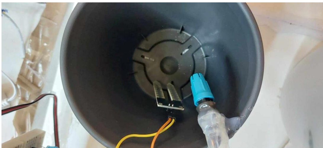
Εικόνα 4.4: Αισθητήρας ελέγχου αυτόματου ποτίσματος
