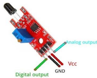
Εικόνα 3.16: Αισθητήρας φλόγας KY-026.
