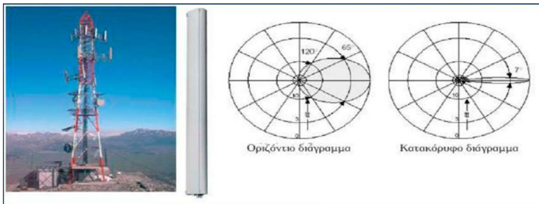
Σχήμα 2.1: Όψη και διαγράμματα ακτινοβολίας κεραιάς κινητής τηλεφωνίας της εταιρίας Kathrein τύπου 739630 για εκπομπή στην συχνότητα των 900MHz, όπως δίνονται από τον κατασκευαστή.
