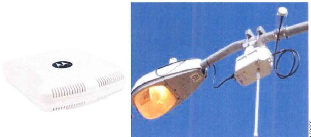
σχ. 1.4.4 Ελεγκτές Δικτύου (Switching Controllers)[12]
