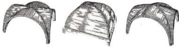
εικ. 28 Βυζαντινή θολοδομία. Από αριστερά ρωμαϊκό σταυροθόλιο, μοναστηριακός θόλος, βυζαντινό σταυροθόλιο (Μπούρας, 1999, σ.114)
