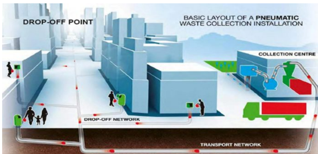
Εικόνα 2.2 Υπόγειο Σύστημα Διαλογής & Διαχείρισης ΑΣΑ
