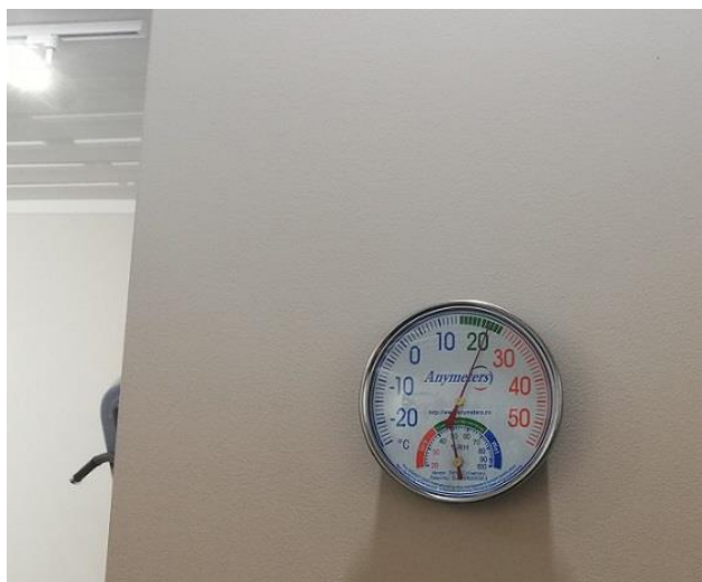
Εικόνα 3: Όργανο ένδειξης θερμοκρασίας και υγρασίας.
