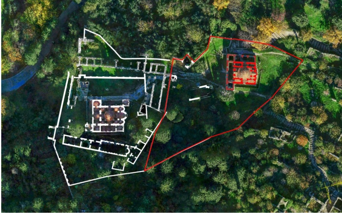
Εικόνα 73: Φωτογραμμετρικός Χάρτης της Μονής Βροντοχίου στον Αρχαιολογικό Χώρο του Μυστρά. Με άσπρο περίγραμμα διακρίνεται η κάτοψη της Μονής σχεδιασμένη από τον Millet, τοποθετημένη σε σημερινό φωτογραμμετρικό υπόβαθρο. Δεξιά διακρίνεται ο ναός των Αγίων Θεοδώρων και η πιθανή αρχική οριοθέτηση της πρώτης Μονής.
