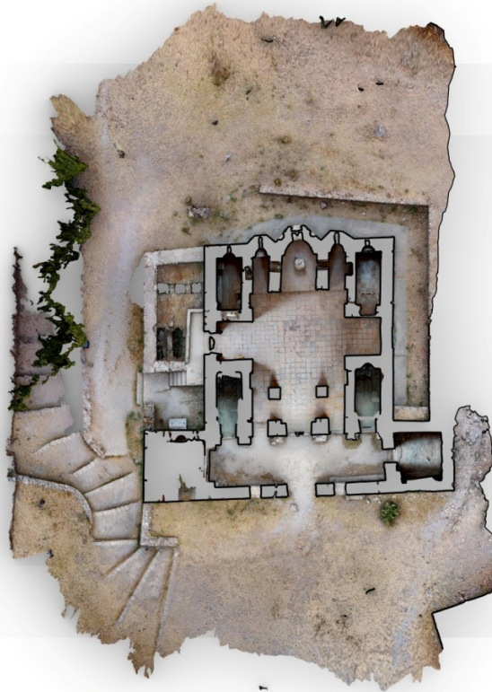
Εικόνα 49: Φωτογραμμετρική αποτύπωση του ναού των Αγίων Θεοδώρων της Μονής Βροντοχίου στον Μυστρά, που πραγματοποιήθηκε για τις ανάγκες της εν λόγω εργασίας. Η αποτύπωση – σχεδίαση έγινε από τον Αγρονόμο –Τοπογράφο μηχανικό Γ. Γιαξόγλου.
