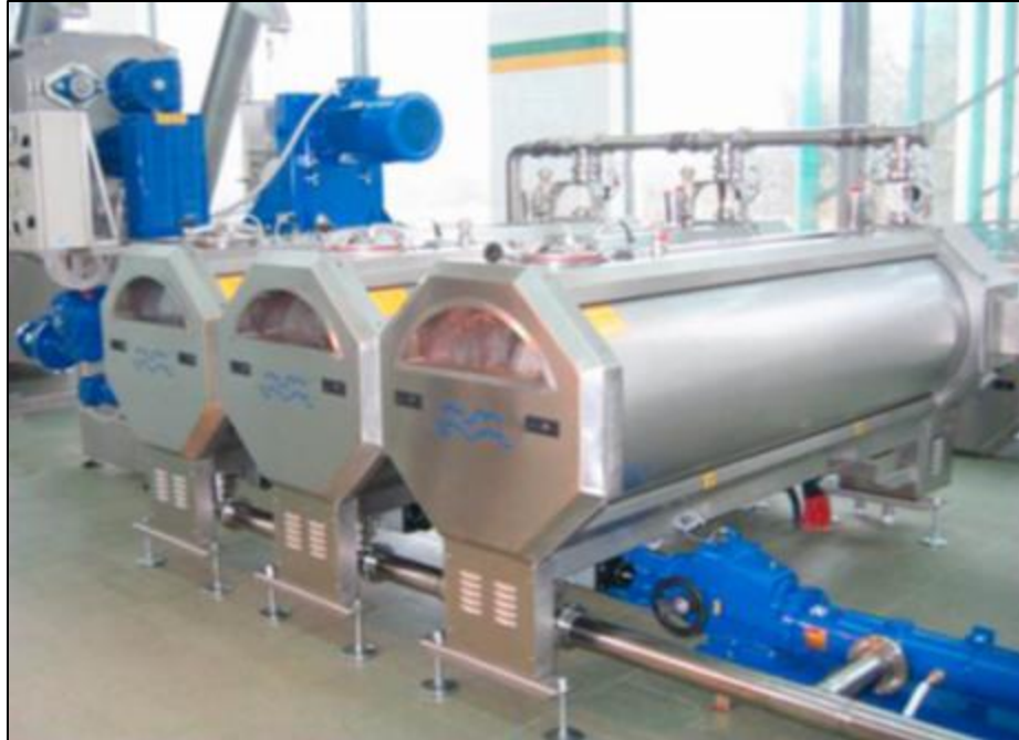
Σχήμα 5.1: Ένας πρωτοποριακός μαλακτήρας σε μια βιομηχανική μονάδα. Αυτό το νέο μηχάνημα έχει χρησιμοποιηθεί σε πειραματικές δοκιμές που πραγματοποιήθηκαν κατά την περίοδο 2007/08, προκειμένου να μελετηθεί η επίδραση του στις θρεπτικές και οργανοληπτικές ιδιότητες του ελαιολάδου (Tamborrino et. al., 2010).
