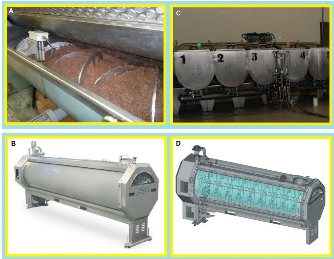
Εικόνα 1.3. Η μηχανή μάλαξης και η εξέλιξή της. (Α) Παραδοσιακό μηχάνημα μάλαξης που χαρακτηρίζεται από σχήμα λίκνου και μη στεγανό κλείσιμο. Αυτός ο τύπος μηχανής προκαλεί σημαντική απώλεια φαινολικών και πτητικών ενώσεων. (Β) Καινοτόμο μηχάνημα μάλαξης που χαρακτηρίζεται από κυλινδρική μόνωση που καλύπτει ολόκληρη την εσωτερική επιφάνεια της δεξαμενής για ταχύτερη και αποτελεσματικότερη θέρμανση της ελαιοζύμης. Η ερμητική στεγανοποίηση διασφαλίζει τον τέλειο έλεγχο της ατμόσφαιρας σε επαφή με την ελαιοζύμη στο μηχάνημα μάλαξης μέσω βαλβίδων για αδρανές αέριο (άζωτο ή αργό). Πηγή: Clodoveo et al., 2014
