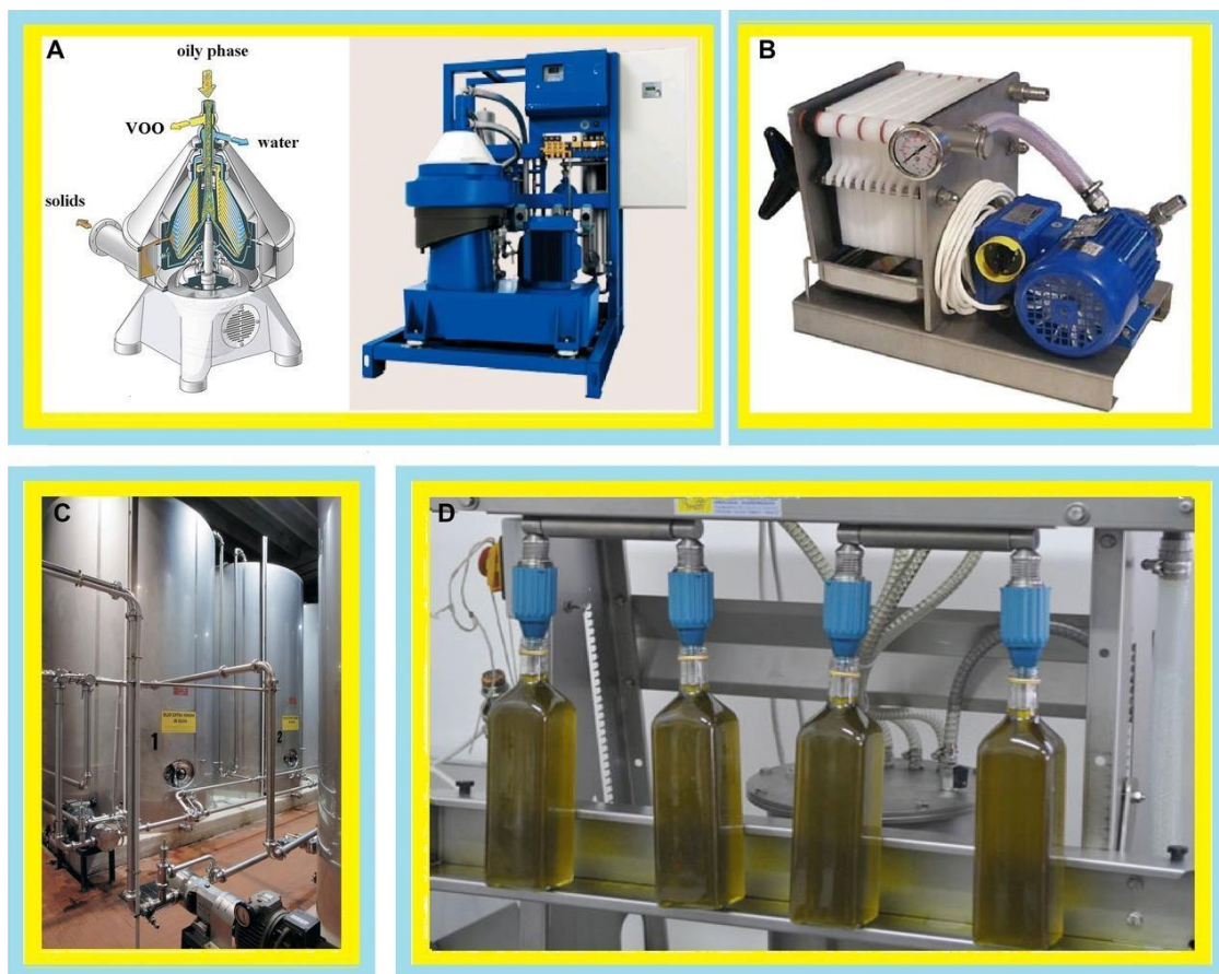
Εικόνα 1.5. Κάθετη φυγοκέντρηση (A), διήθηση (B), αποθήκευση (C) και εμφιάλωση (D). Πηγή: Clodoveo et al., 2014
