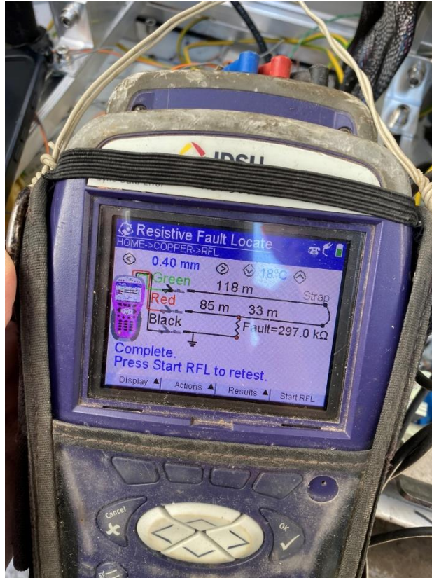
Εικόνα 6.7 Τα αποτελέσματα του οργάνου για δοκιμή RLF(single pair method). Όπως παρατηρούμε και στην οθόνη, η DTF(απόσταση μέχρι σφάλμα) είναι 85m , η DTS(απόσταση μέχρι το πιο απομακρυσμένο άκρο του βρόχου) είναι 118m, η DSTF(απόσταση από το σημείο σφάλματος μέχρι το πιο απομακρυσμένο άκρο) είναι 33m.
