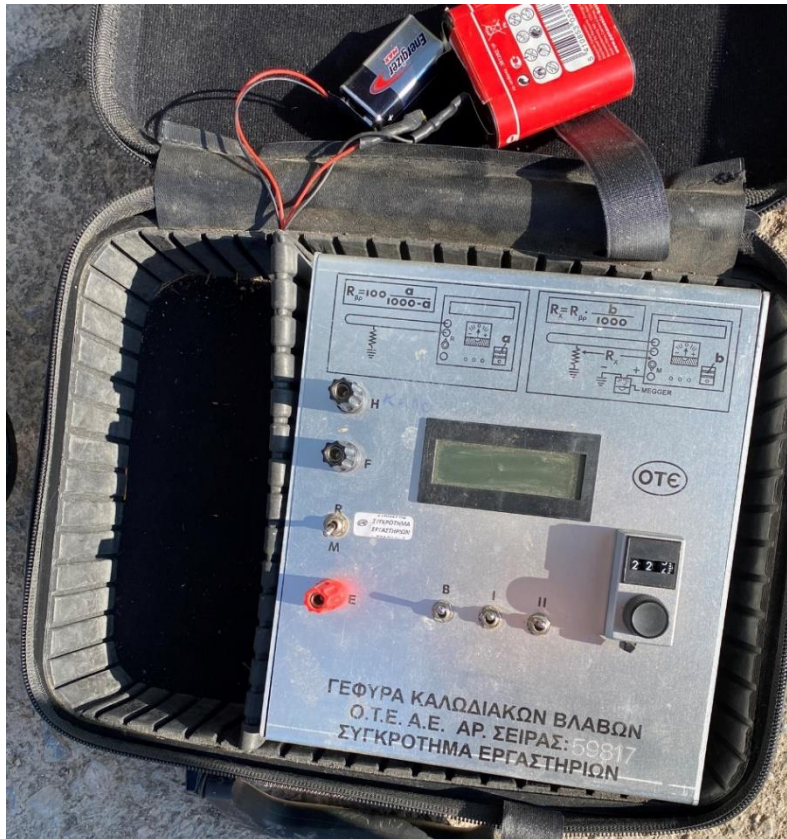
Εικόνα 6.1 Η διάταξη γέφυρας(test set)
